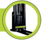
Dank dem hydraulisch angetriebenen Hubmodul mit Gabeln ist der AMR in der Lage ganze Europaletten direkt vom Boden aufzunehmen und wieder abzustellen. Außerdem besteht auch die Möglichkeit Europaletten bis zu einer Höhe von max. 3.000mm zu übergeben. Die Positioniergenauigkeit ist kleiner +/- 10mm. Die Palettenposition wird anhand einer Bildverarbeitung erkannt.
