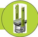
Der Transporter ist ein autonomer mobiler Roboter (AMR), welcher sich für Nutzlasten bis zu 90kg eignet.
