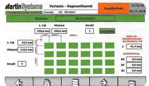
Smile heißt die grafische Eingabemaske der Speedy-Zelle. Solche Masken bieten die Möglichkeit, den Roboter ohne spezielle Programmier-Vorkenntnisse einzurichten.
