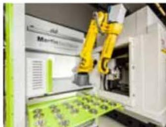
Aufgabe an fast jedem Ort übernehmen. Mit ihrer Flexibilität ist die Speedy in der Lage, mit unterschiedlichsten Bearbeitungsmaschinen zusammenzuarbeiten. Auf der Basis von ›Profinet‹ und ›Profisafe‹ ist sie für die Kommunikation in der modernen Maschinenwelt bestens ausgestattet. Die wichtigste Voraussetzung für ausdauerndes Arbeiten ist aber ihr großer Speicher für
