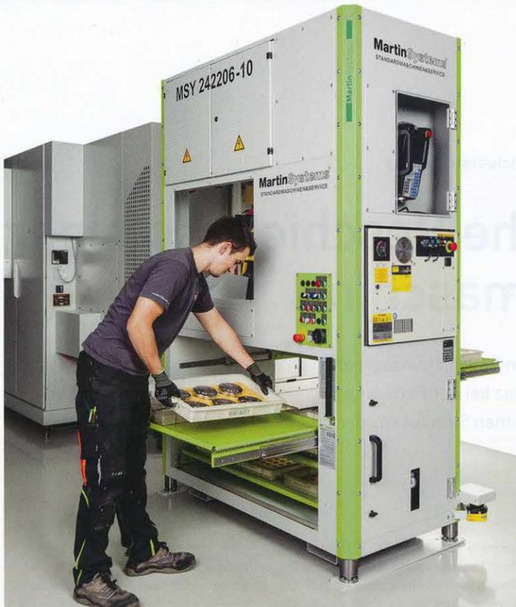
3 Die mobile Anlage ist von zwei Seiten aus zugänglich, sodass die Schubladen noch während des Arbeitsvorgangs beladen werden können (© MartinSystems)
