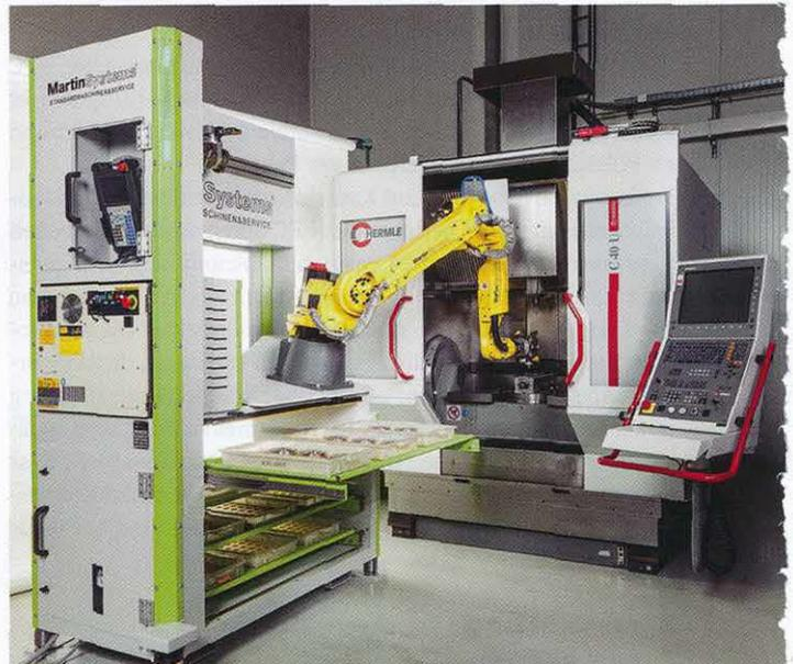
2 In den Schubladen der Speedy liegen Inlays, auf denen die Rohteile gelagert sind [© MartinSystems]
