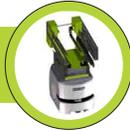
Der MagMover ist ein autonomer mobiler Roboter (AMR), welcher sich für Nutzlasten bis zu 40 kg eignet.
